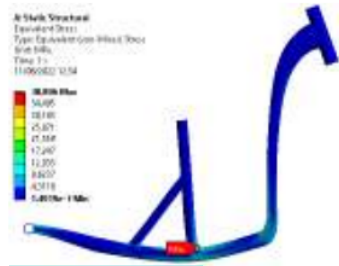
Gambar 5 Hasil simulasi: maximum tensile strength
