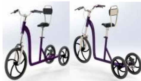
Gambar 8 rancangan rangka sepeda roda tiga tanpa pedal
