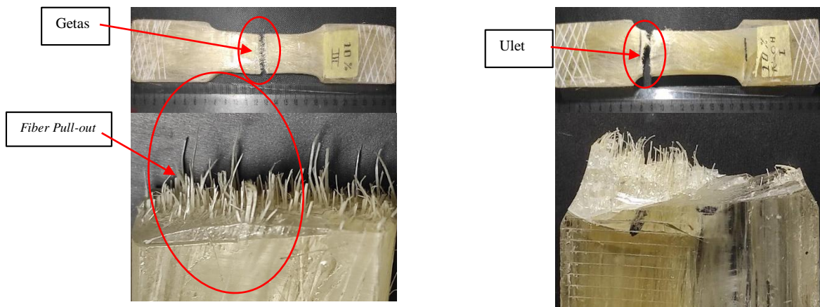
Gambar 5. (a) Foto makro serat 10 % sebelum alkalisasi NaOH (b) Foto makro serat 10 % setelah alkalisasi NaOH 5%
