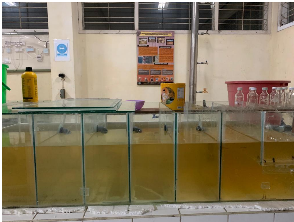
Gambar 2. Seeding Reaktor ABR
