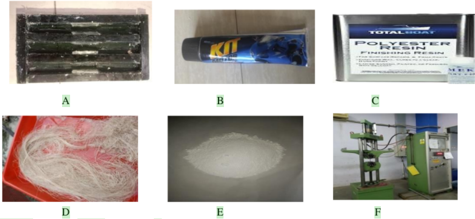
Gambar 1. Alat dan Bahan Penelitian A). Cetakan, B). Pelumas Cetakan, C). Resin Polyester, D). Serat Eceng Gondok, E).Zinx Oxide, F). Alat Uji Tarik
