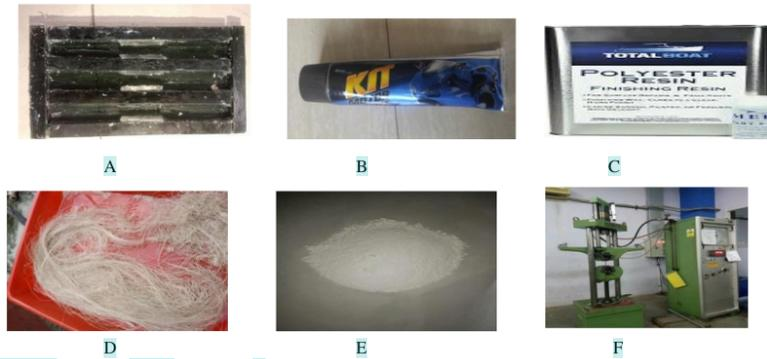
Gambar 1. Alat dan Bahan Penelitian (A). Cetakan, B). Pelumas Cetakan, C). Resin Polyester, D). Serat Eceng Gondok, E). ZnO, F). Alat Uji Tarik
