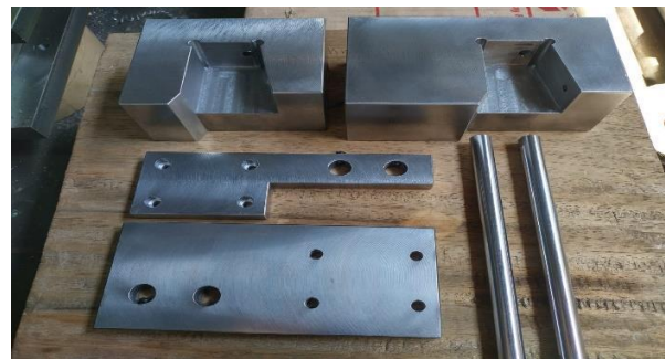
Gambar 9. Komponen-komponen jig and fixture setelah proses manufaktur
