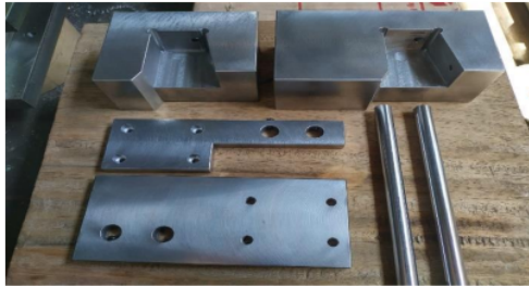
Gambar 9 Komponen-komponen jig and fixture setelah proses manufaktur
