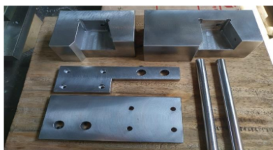
Gambar 9. Komponen-komponen jig and fixture setelah proses manufaktur
