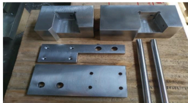
Gambar 9. Komponen-komponen jig and fixture setelah proses manufaktur
