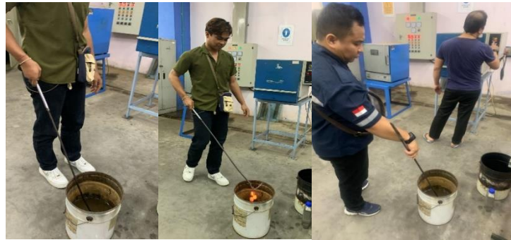
Gambar 4. 3 Proses Quenching dengan air garam Sumber: (Lab. Politeknik negeri Malang)
