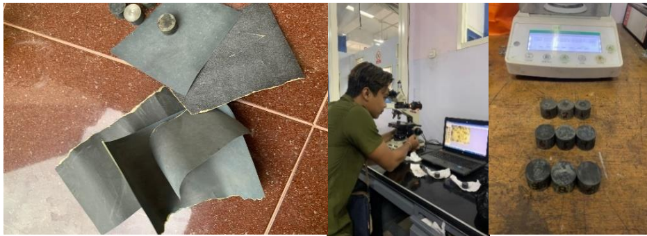
Gambar 4. 5 Proses Pemolesan, uji struktur Mikro,dan Timbangan Berat setelah proses Hardening
