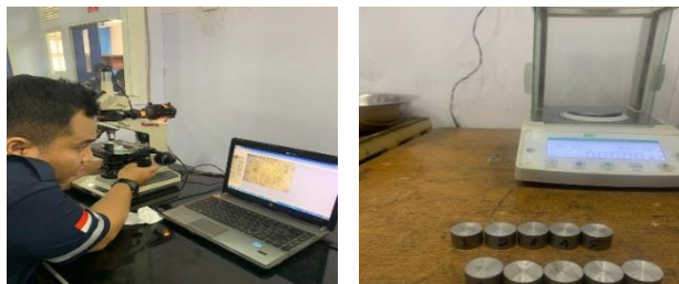
Gambar 4. 1 pengujian struktur mikro dan berat awal baja ST 42 tanpa perlakuan
