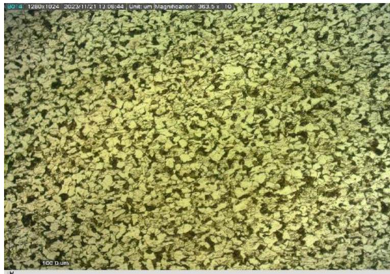
Gambar 4. 6 Hasil Pengujian Struktur Mikro Baja ST 42 Tanpa Perlakuan (Etsa, Nital konsentrasi 2%)
