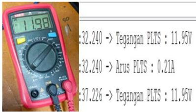
Gambar 5. Sensor Tegangan dan Multimeter
