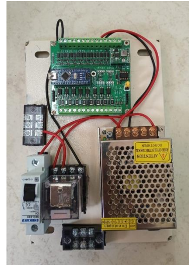
Gambar 17. Panel Kontrol Daya Kepala Lab Otomasi
