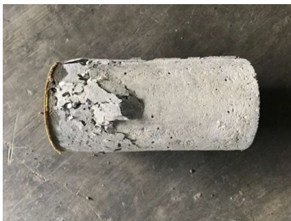
Gambar 4. 1 Pola Retak Pada Silinder Beton Ringan
