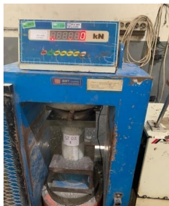
Gambar 3. 10 Pengujian Kuat Tekan
