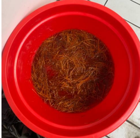
Gambar 3. 3 Proses Treatment Serat Bambu Menggunakan NaOH
