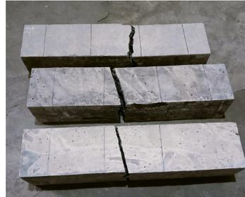
Gambar 3. Pola Retak Pada Pengujian Kuat Tarik Lentur Beton
