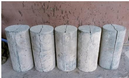
Gambar 2. Pola Retak Pada Pengujian Kuat Tarik Belah Beton
