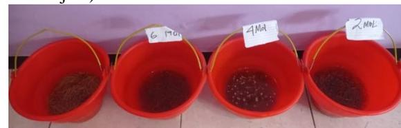
Gambar 4. 1 Proses Uji Penyerapan Air
