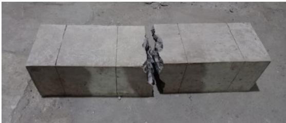
Gambar 4. 3 Pola Patah Kuat Lentur pada Balok
