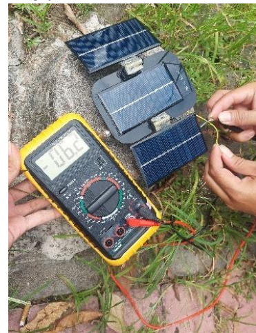
Gambar 14. Langkah pengujian panel surya
