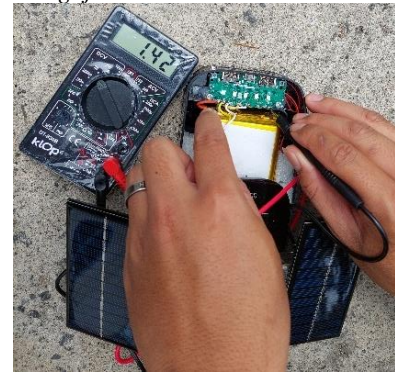
Gambar 16. Pengukuran baterai powerbank
