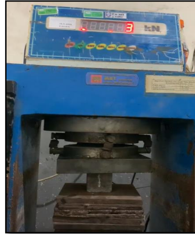
Gambar 2. Pengujian Kuat Tekan
