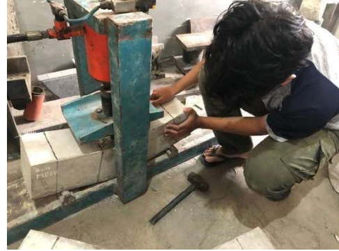
Hasil uji kuat lentur beton dengan variasi fiberglass mesh
