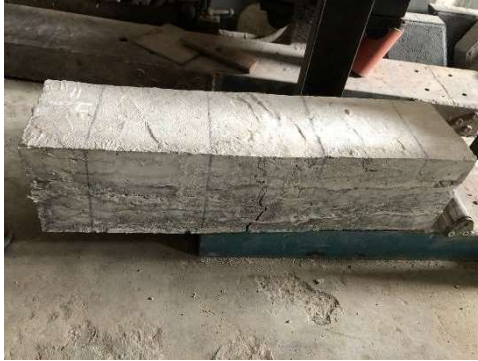
Hasil uji kuat lentur beton dengan variasi fiberglass matt
