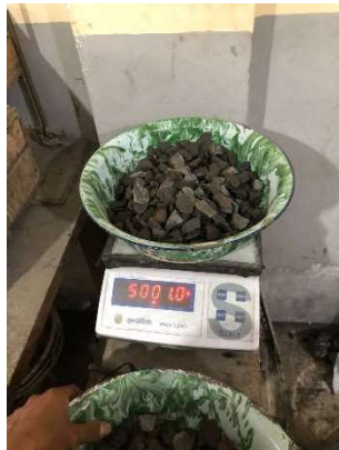
Pelaksanaan timbang agregat kasar untuk uji ssd
