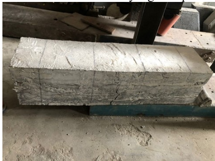
Gambar 4. 6. Beton Balok Fiberglass Matt Setelah Dilakukan Pengujian
