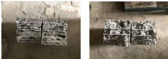
Gambar 4. 7. Kondisi Layer Fiberglass Matt Setelah Dilakukan Pengujian
