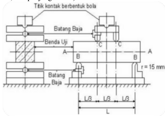
Gambar 2. 4. Benda uji, perletakan dan pembebanan 2 titik
