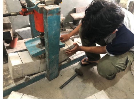
Gambar 4. 8. Beton Balok Fiberglass Mesh Setelah Dilakukan Pengujian
