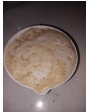
Gambar 3.1 Campuran Bakteri Bacillus subtilis dan Komponen Tambahan
