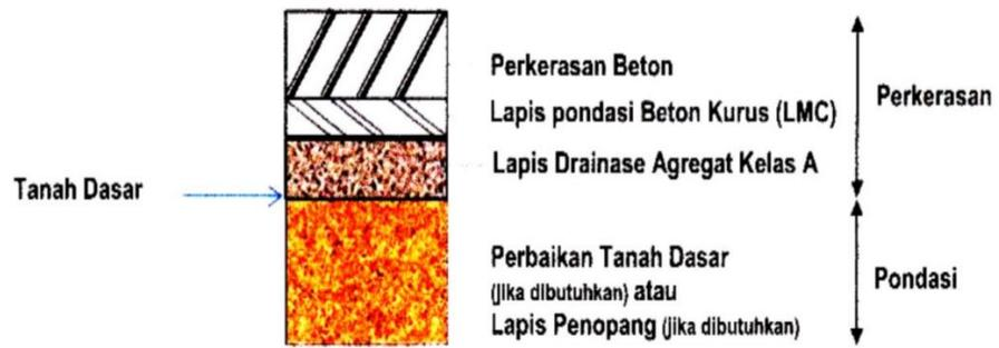
Struktur Perkerasan Kaku pada Permukaan Tanah Asli (At Grade)
