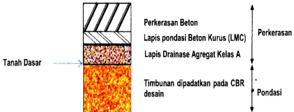
Struktur Perkerasan Kaku Pada Timbunan
