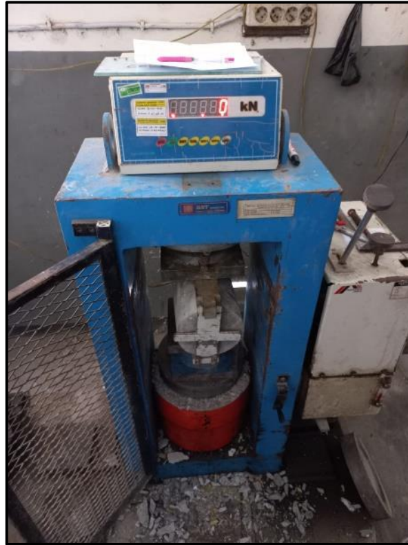
Gambar 3 . 4 Pengujian Kuat Tarik Belah.
