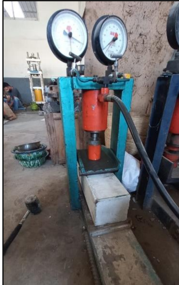
Gambar 3 . 3 Pengujian Kuat lentur.
