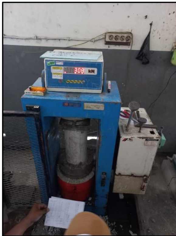
Gambar 3 . 5 Pengujian Kuat Tekan.
