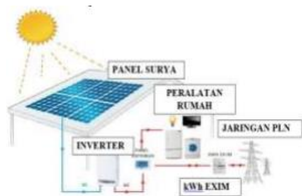
Gambar. 5 skema PLTS atap
