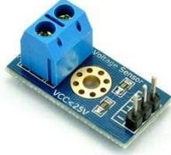
Gambar 7. Sensor tegangan DC
