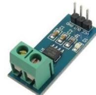
Gambar 6. Sensor arus module ACS712
