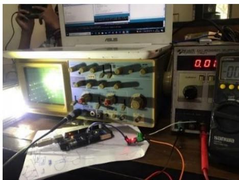
Gambar 22 Pengujian sensor Arus
