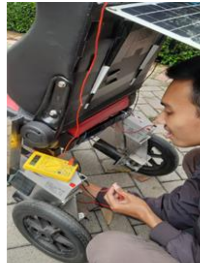
Gambar 21. Rangkaian Pengambilan Daya Baterai
