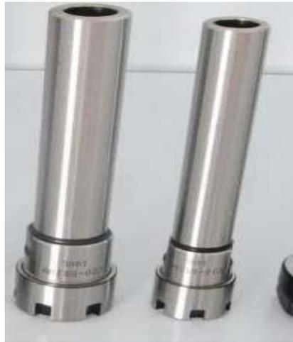
Gambar 2.6. Poros Spindel (<http://teknik-mesin1.blogspot.com>)
