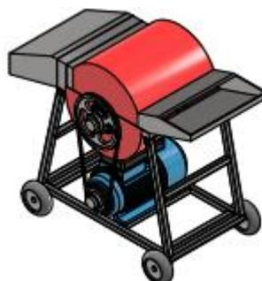
Gambar 3. 2 Desain Mesin Pencacah Batang Singkong
