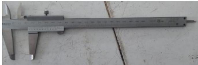
Gambar 3. 3 Jangka Sorong 0,05 mm
