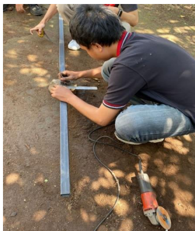
Gambar 2 : Pembuatan pola besi siku 4x4 inch yang digunakan sebagai kerangka mesin pencacah batang singkong
