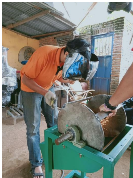
Gambar 6 : proses pengelasan kerangka penyangga mesin pencacah batang singkong
