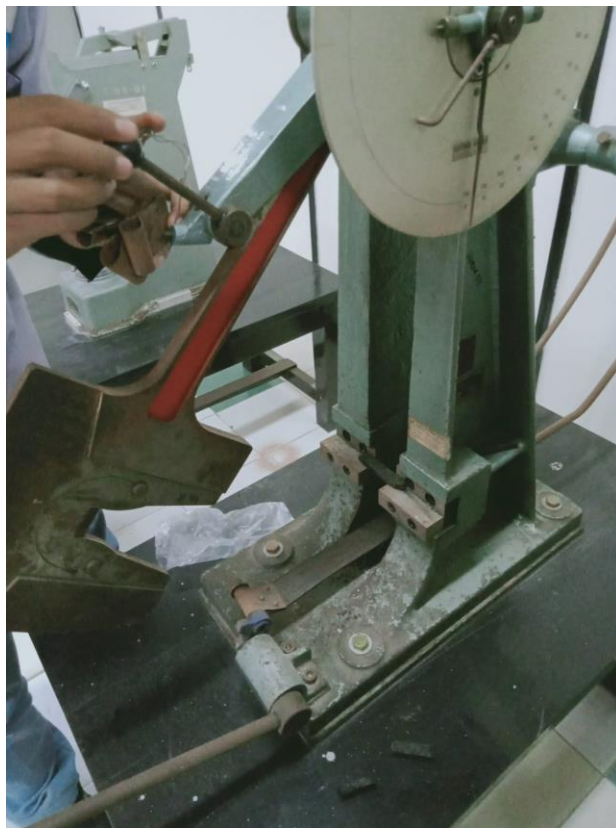
Gambar 14 : Proses uji impact charpy untuk mengukur kekuatan spesimen eco-paving block dari batang singkong dan plastic PET
