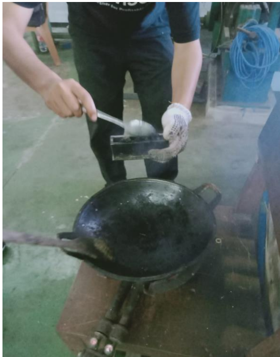
Gambar 11 : Proses memasukan material yang sudah tercampur antara plastic PET dan batang singkong ke dalam dies
