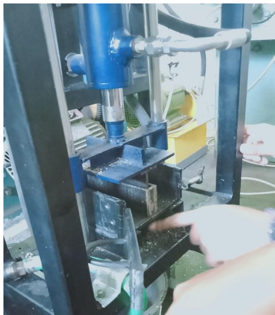
Gambar 12 : Proses press material untuk dipadatkan sampai 220 Psi dengan menggunakan mesin press hidrolis
