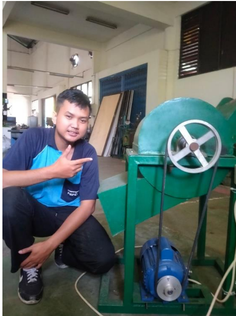
Gambar 7 : Mesin pencacah batang singkong
