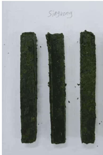
Gambar 13 : Hasil campuran material eco-paving block yang sudah di press
