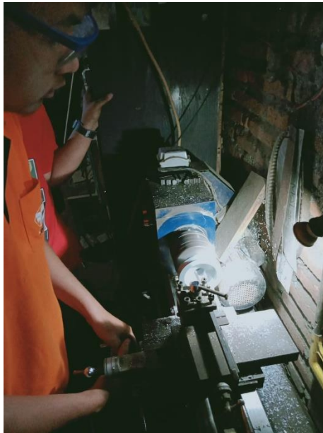
Gambar 5 : proses pembubutan diameter dalam pada pulley
