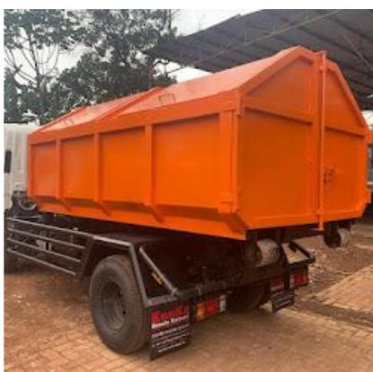
**Gambar 5.** Alat Pengangkut Arm Roll Truck
