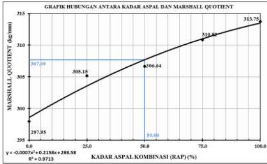
Gambar 11: Grafik Hubungan Antara Kadar Aspal Kombinasi (RAP) dan Marshall Quotien Sumber: Hasil Pengolahan Data Penelitian
