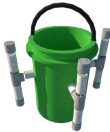
Gambar 3. Rancang Bangun Perangkat Mini Composter M3 (Dokumentasi, 2019)
