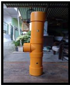
**Gambar 2.** Pipa Saluran Udara Mini Composter M3 (Dokumentasi, 2019)
