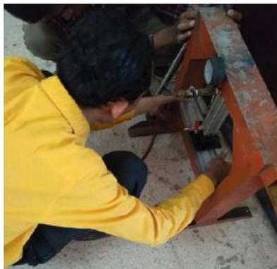
**Gambar 6.5 Pengepresan biokomposit bubuk koran**
