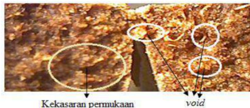
Gambar 5.1 Foto Makro Komposit Serbuk Kelapa Dengan Matrik Polyester
