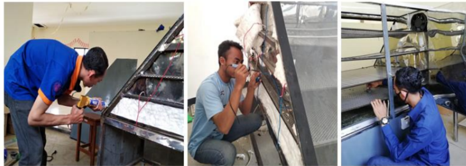
Gambar 7. Proses perbaikan elemen pemanas
