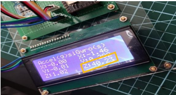
Gambar 4.31 Pengujian axis Z gyroscope menggunakan busur derajat.
