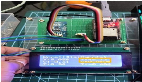
Gambar 4.23 Nilai axis X gyroscope pada tampilan LCD.
