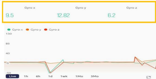
Gambar 4.6 Data axis gyroscope saat ada pergerakan pada aplikasi smartphone .
