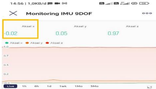
Gambar 4.12 Pergeseran axis X accelerometer pada aplikasi smartphone .
