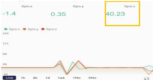
Gambar 4.30 Nilai axis Z gyroscope pada aplikasi smartphone.
