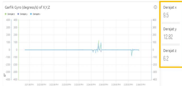
Gambar 4.5 Data axis gyroscope ketika ada pergerakan pada website.
