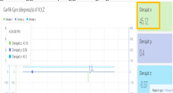
Gambar 4.21 Nilai axis X gyroscope pada website .
