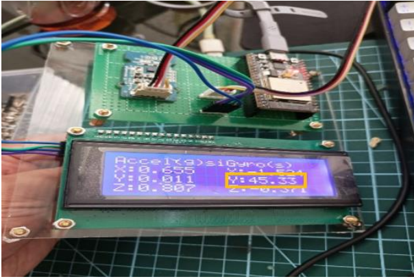
Gambar 4.27 Nilai axis Y gyroscope pada tampilan LCD.
