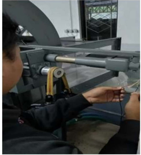
Gambar 5. Penyambungan Kabel Sensor
