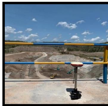
Gambar 3.8 Pengambilan Data Menggunakan GNSS
