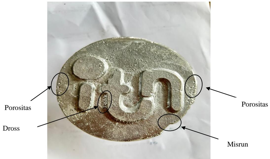
Gambar 5. Hasil Pengujian alat bantu pengecoran logam dengan metode rotary dengan RPM 100
