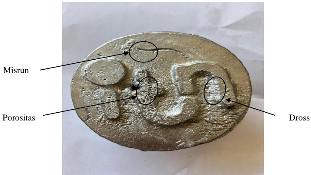
Gambar 4. Hasil pengujian pengecoran logam konvensional
