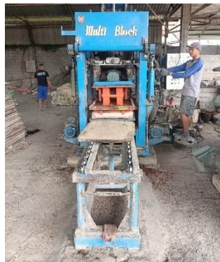
Gambar 1.2 Proses Mencetak Paving Block Dengan Mesin Cetak
