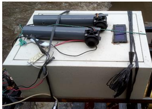
Gambar 3. 6 Flowmeter (Sumber: dokumentasi pribadi)
