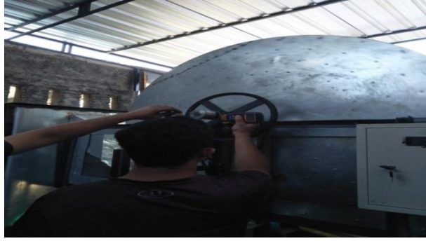
Gambar 3.27 Pengukuran putaran poros turbin dengan tachometer (Sumber : Dokumen pribadi)
