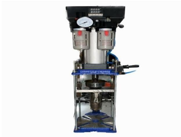
Gambar 1. Mesin injeksi molding semi otomatis
