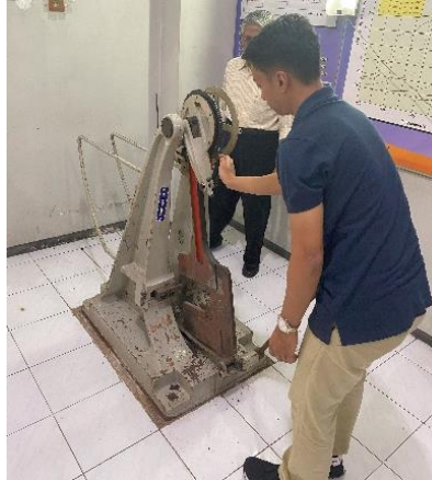
Gambar 3. 25 Pengujian Impact (Sumber : Ilham, 2024)
