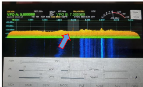
Gambar 14. Tampilan Pengujian Frekuensi dengan wwv frequency calibration 5Mhz
