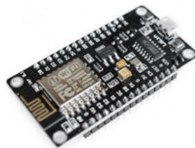
Gambar 1. NodeMCU ESP8266
