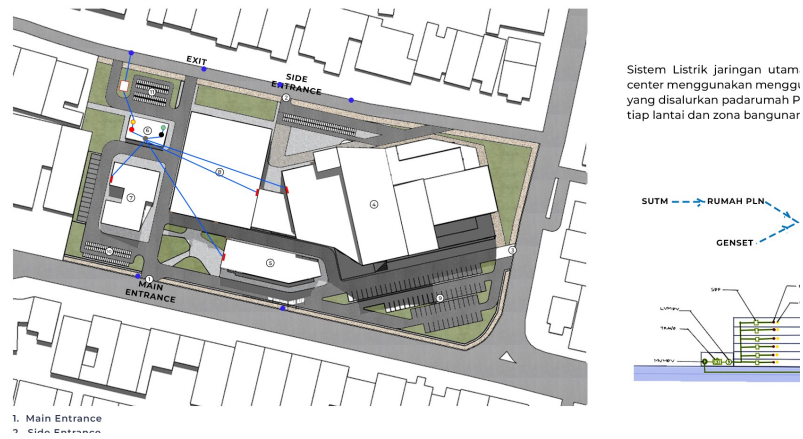
Gambar 7. 10 Skematik Listik Jaringan Tapak Sumber: Analisis pribadi, 2024
