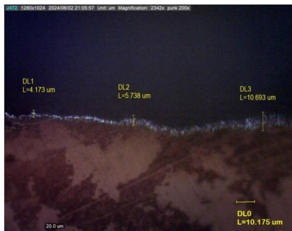
Gambar 2 Hasil Struktur Mikro Ketebalan lapisan Karbon Laju Alir 5 cm<sup>3</sup>/menit
