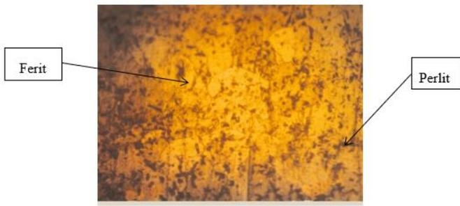
Gambar 11 Hasil Struktur Mikro Tanpa Perlakuan Baja AISI 1042
