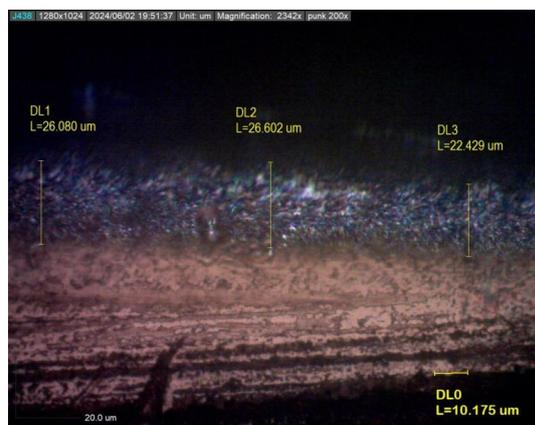
Gambar 4. Hasil Struktur Mikro Ketebalan lapisan Karbon Laju Alir 25 cm<sup>3</sup>/menit
