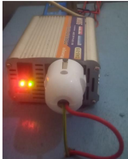
Gambar 4. 15 Inverter yang sedang beroperasi
