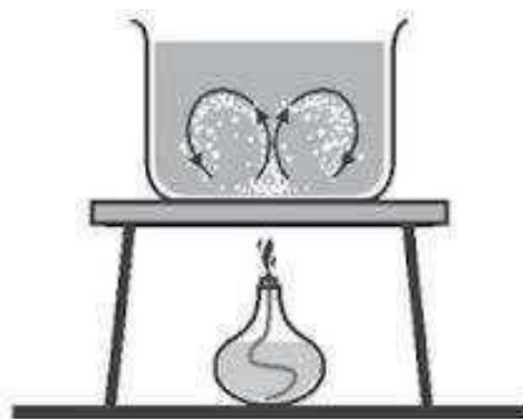
Gambar 2. 5 Proses Perpindahan Panas Secara konveksi
